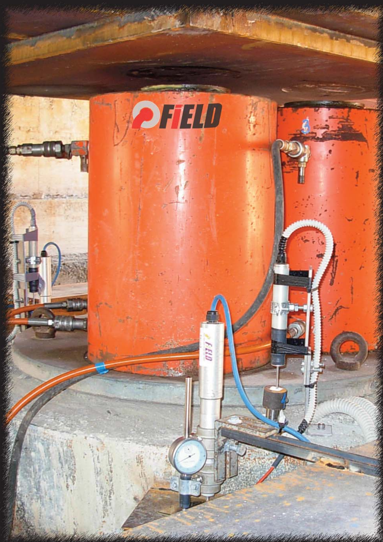
Статические испытания нагрузкой - Lecco
