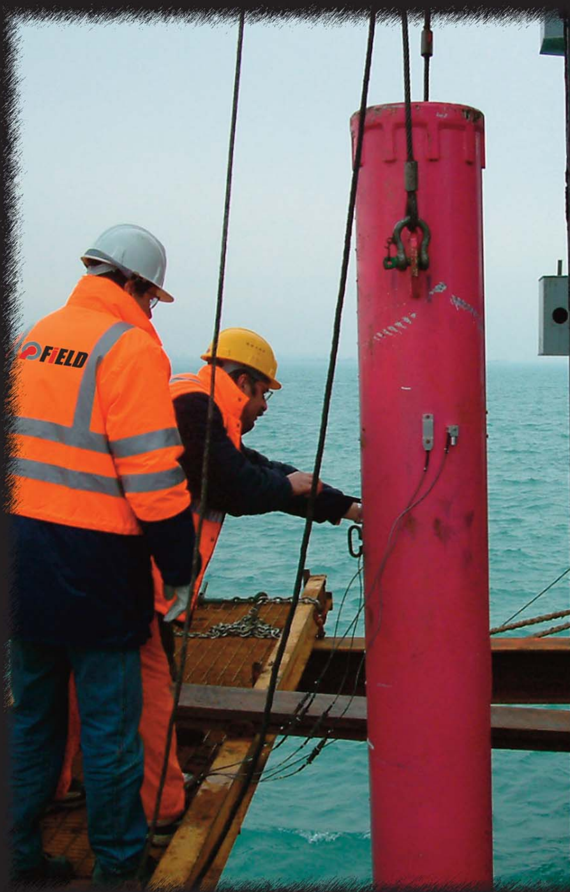
Динамические испытания нагрузкой - Chioggia
