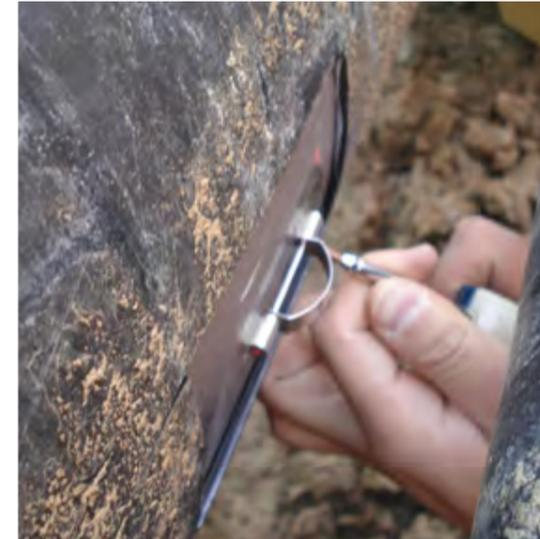
Gli estensimetri vengono generalmente fissati sulla superficie in acciaio della condotta costituite da n.3 sensori disposti a 120° l'uno dall'altro.
