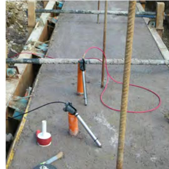
Il risultato è visualizzato in una diagrafia che permette di rilevare gli eventuali difetti presenti nella struttura in esame.
