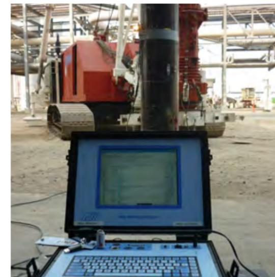
Tutte le prove sono eseguite in accordo alle norme di riferimento (ASTM D4945-89) o sono progettate ed eseguite secondo le specifiche necessità del Cliente.
