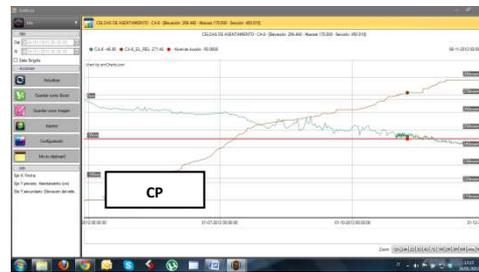
Si los valores de los instrumentos sobrepasan los umbrales de seguridad predeterminados, el WMS puede ser configurado para que el servidor envíe alarmas mediante sms y e-mail a los móviles de las personas elegidas.
