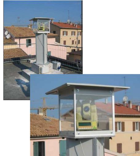
Imagen WMS para monitoreo topográfico
